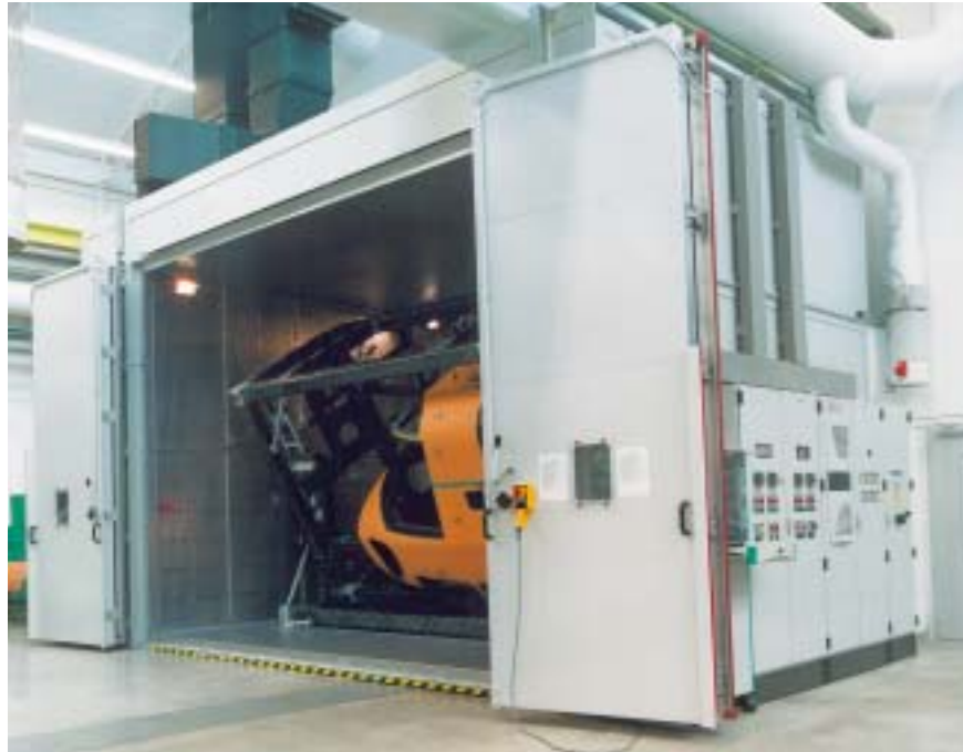
Temperofen mit herausfahrbarem Drehgestell zur Aufnahme von CFK-Hubschrauber-Cockpits Tempering oven with removable rotary rack for fastening of CFK helicopter cockpits.
